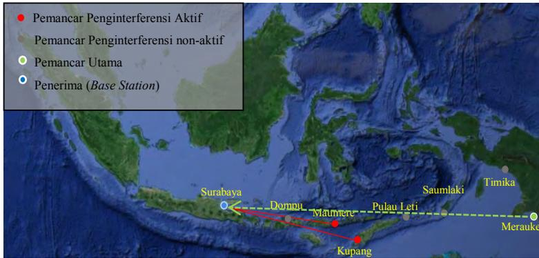
**Gambar 3.5** Contoh kondisi simulasi pengujian kinerja SIR dengan 2 link interferensi (Maumere&Kupang), pada pemancar utama Merauke
