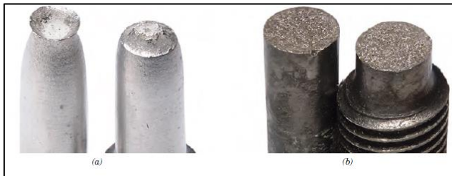
Gambar 2.14 Penampakan (a) Patah Ulet ( Cup and Cone ) pada Aluminium, dan (b) Patah Getas pada Mild Steel (Callister, 2007)
