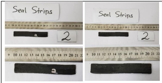
Gambar 4.1 Pengamatan pada Seal Strips Kode 2 yang Mengalami Kegagalan
