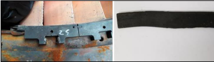
Gambar 3.2 (a) Sistem Ring Segment pada Turbin Gas, (b) Seal Strips
