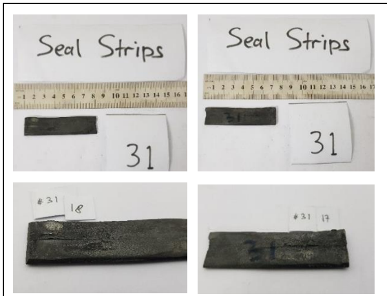
Gambar 4.4 Pengamatan pada Seal Strips Kode 31 yang Mengalami Kegagalan
