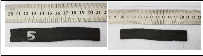
Gambar 4.2 Pengamatan pada Seal Strips Kode 5 yang Mengalami Kegagalan
