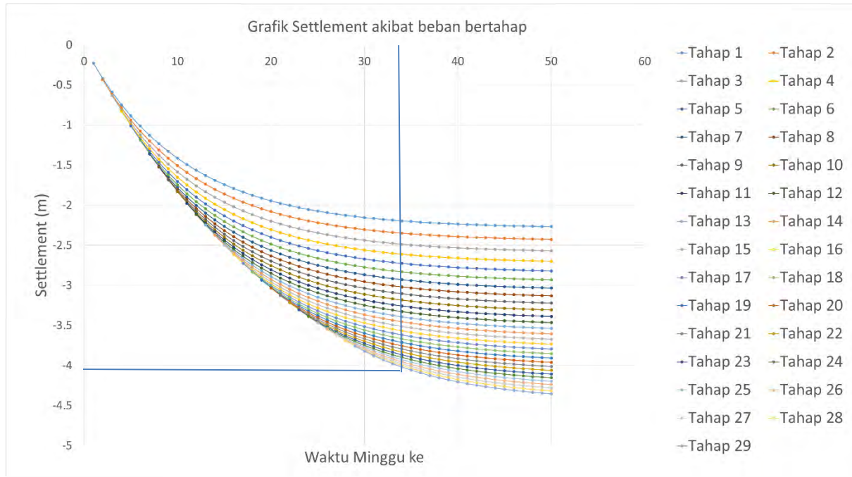
Gambar 5.5 Settlement tiap tahapan timbunan PVD segitiga dengan jarak 1,5 m pada Zona A.
