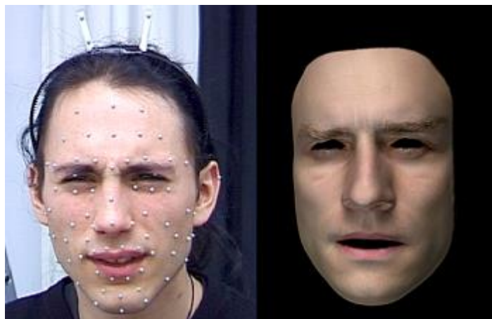
Gambar 2.2 Pengambilan data motion capture (kiri) dan implementasinya di model wajah 3D(kanan) (Curio, et al., 2006)
