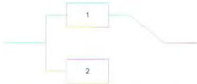
Gambar 2.7 Sistem dengan susunan standby
