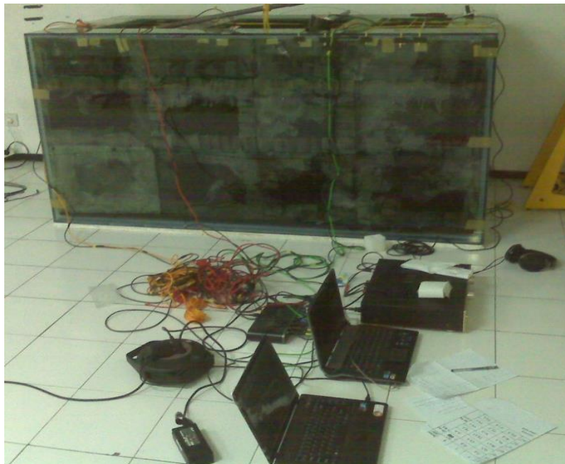
Konfigurasi transmitter-receiver pengambilan data tangki uji mini semi tanpa gaung
