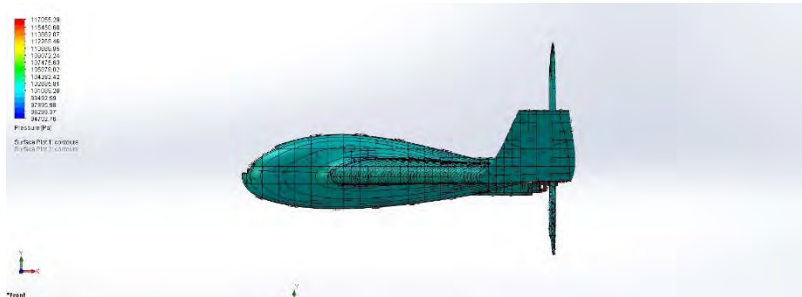
Gambar 4.6 Kontur tekanan statis tampak samping
