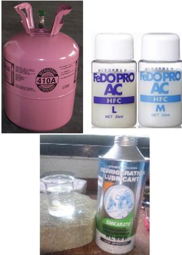
Gambar 3.5 Tabung R410A, *nanofluids* R410A, dan pelumas Emkarate tipe RL 68 H.
