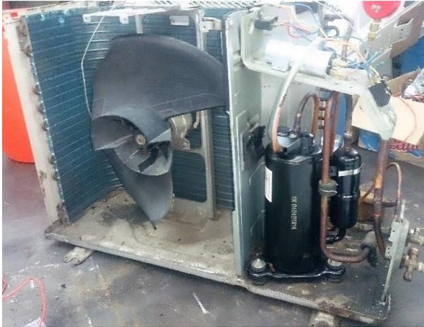
Gambar 2.7 Kondensator dan kompresor sebagai sebuah kesatuan *outdoor unit*
