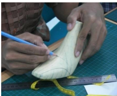
Gambar 4.3 Pembuatan Pola Sepatu
