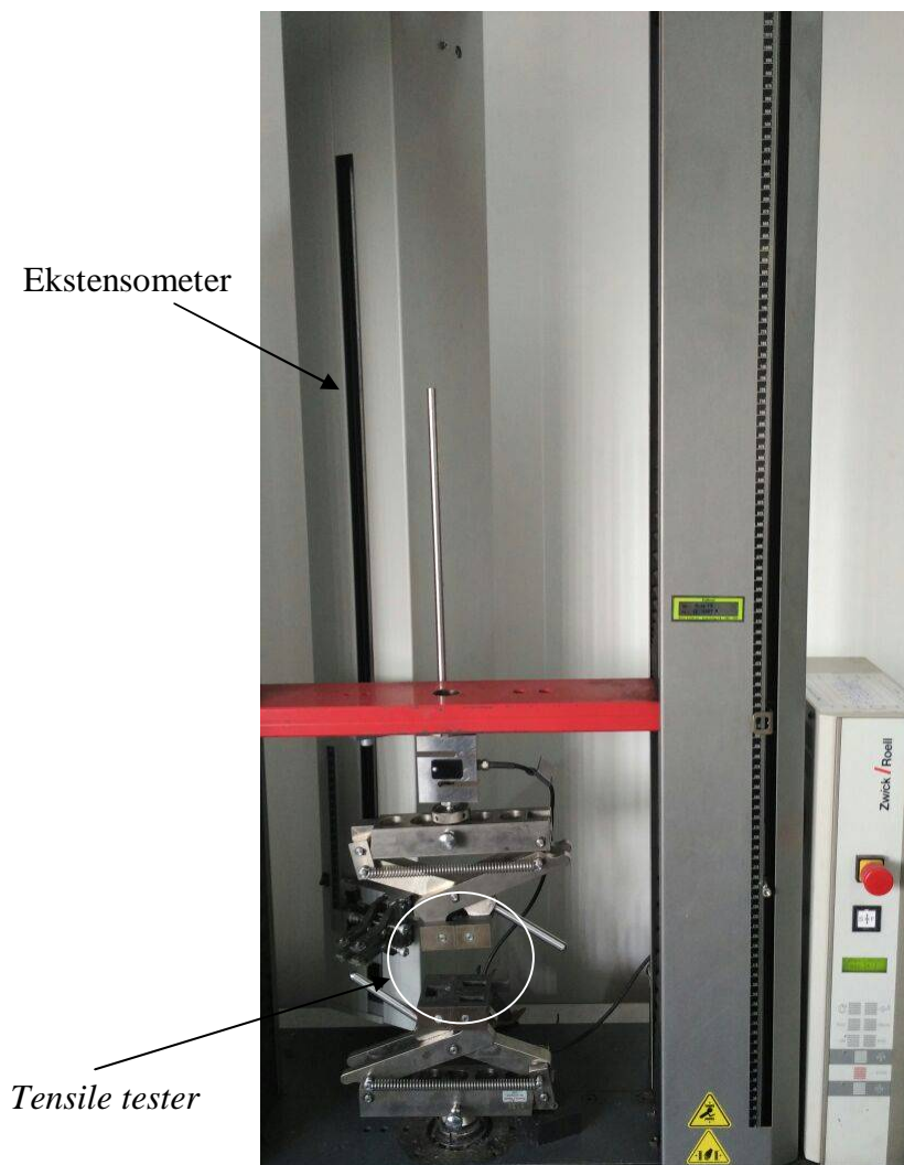
Gambar 4.12 Pengujian Kekuatan Tarik ( Tensile Strength ) dan Kemuluran ( Elongation )
