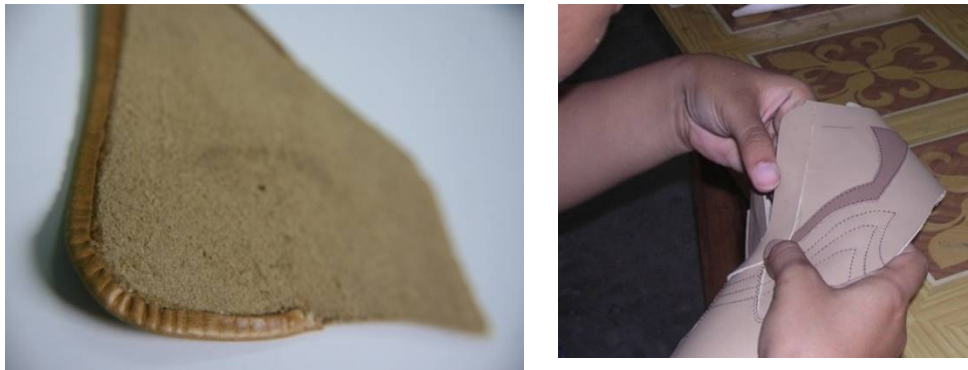
Gambar 4.6 Proses Folding (kiri) dan Menyambung (kanan)
