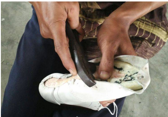
Gambar 4.8 Proses Lasting Manual (kiri) dan Mesin (kanan)
