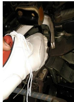
Gambar 4.8 Proses Lasting Manual (kiri) dan Mesin (kanan)
