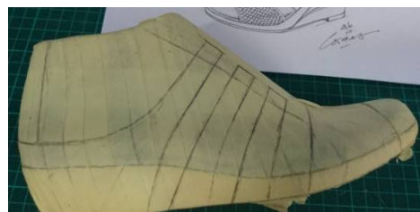
Gambar 4.3 Pembuatan Pola Sepatu
