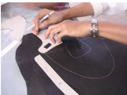
Gambar 4.4 Pemotongan Bahan Manual (kiri) dan Mesin (kanan)
