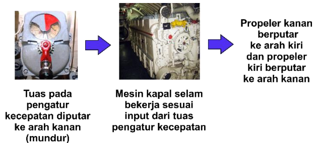
Gambar 2.14 Proses terjadinya gerakan mundur pada kapal selam [28].
