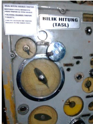
Gambar 2.15 Peluncur torpedo pada bilik hitung.
