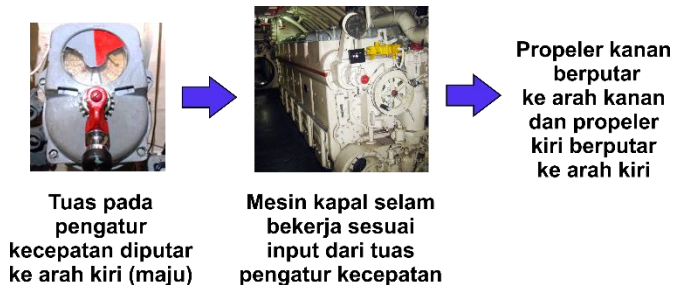
Gambar 2.13 Proses terjadinya gerakan maju pada kapal selam [28].
