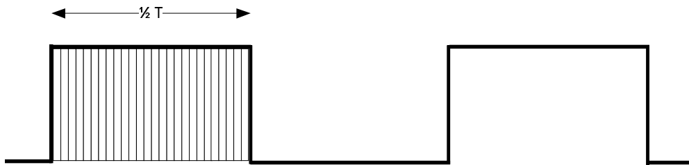
Gambar 4.18. Perhitungan lebar pulsa hall effect sensor oleh timer 2
