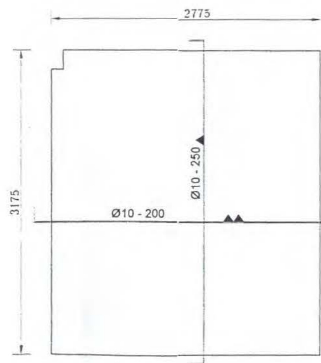
PENULANGAN PLAT PRACETAK B
