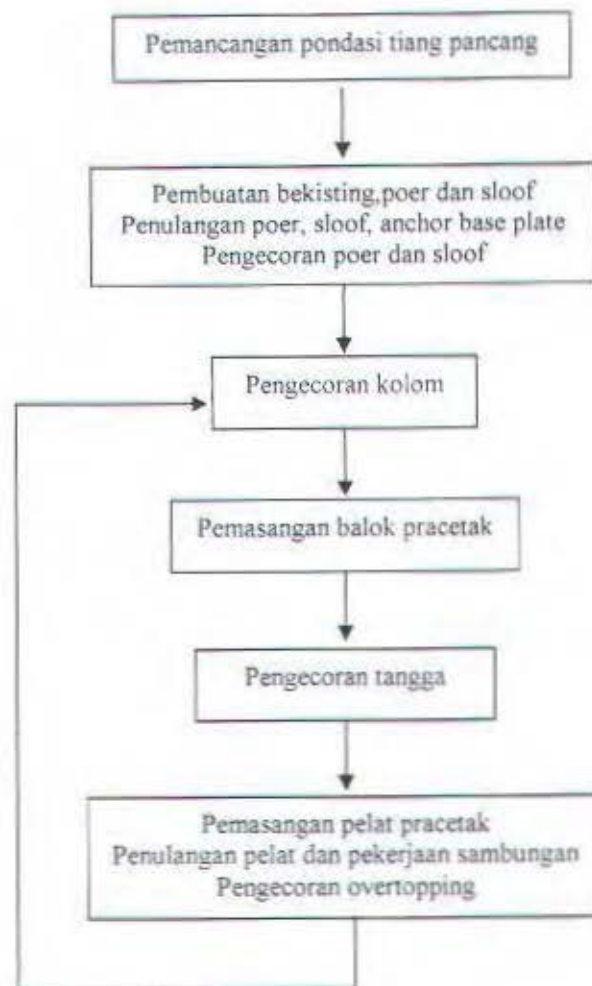
Bagan tahapan-tahapan pemasangan elemen beton pracetak
