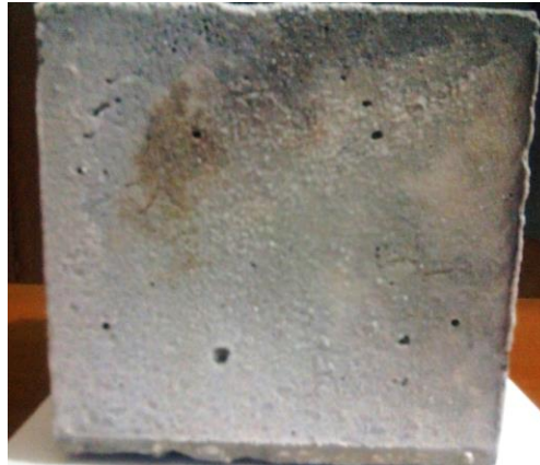
Gambar 5.21 Lapisan Tipis Kristal Garam yang Terbentuk di Permukaan Beton
