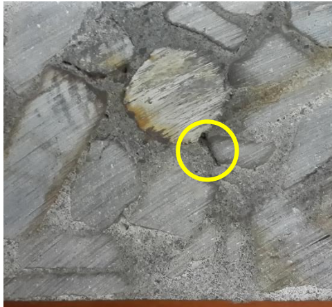
Gambar 5.4 Pengamatan Kondisi Visual Pengujian Korosi Metode Galvanostatik Hari Kedua
