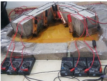
Gambar 5.5 Pengamatan Kondisi Visual Pengujian Korosi Metode Galvanstatik Hari Keempat
