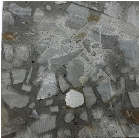
Gambar 5.35 Penampang Beton pada Kondisi Fully Submerged Bulan Pertama
