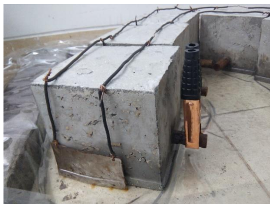
Gambar 5.3 Pengamatan Kondisi Visual Pengujian Korosi Metode Galvanstatik Hari Pertama
