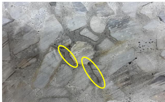
Gambar 5.5 Pengamatan Kondisi Visual Pengujian Korosi Metode Galvanstatik Hari Keempat
