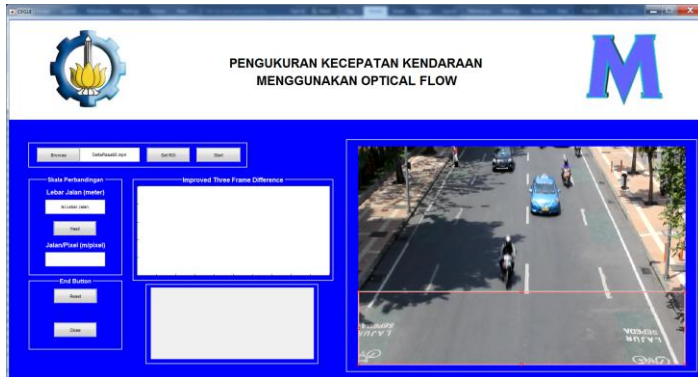
Gambar 4.16 Kotak merah pada frame tersebut adalah area ROI yang dipilih.
