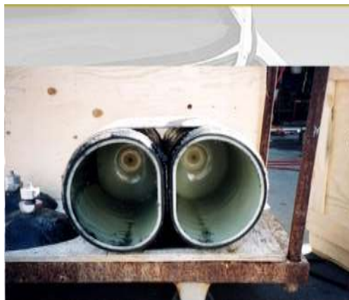
Gambar II.4 Tabung CNG Tipe 4
