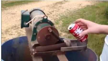
Gambar 2.6 Mesin pengepres kaleng minuman dengan mekanisme eksentrik .
