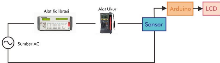
Gambar 4.13 Skema Pengujian Sensor Arus
