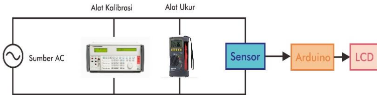
Gambar 4.15 Skema Pengujian & Pengukuran Sensor Tegangan
