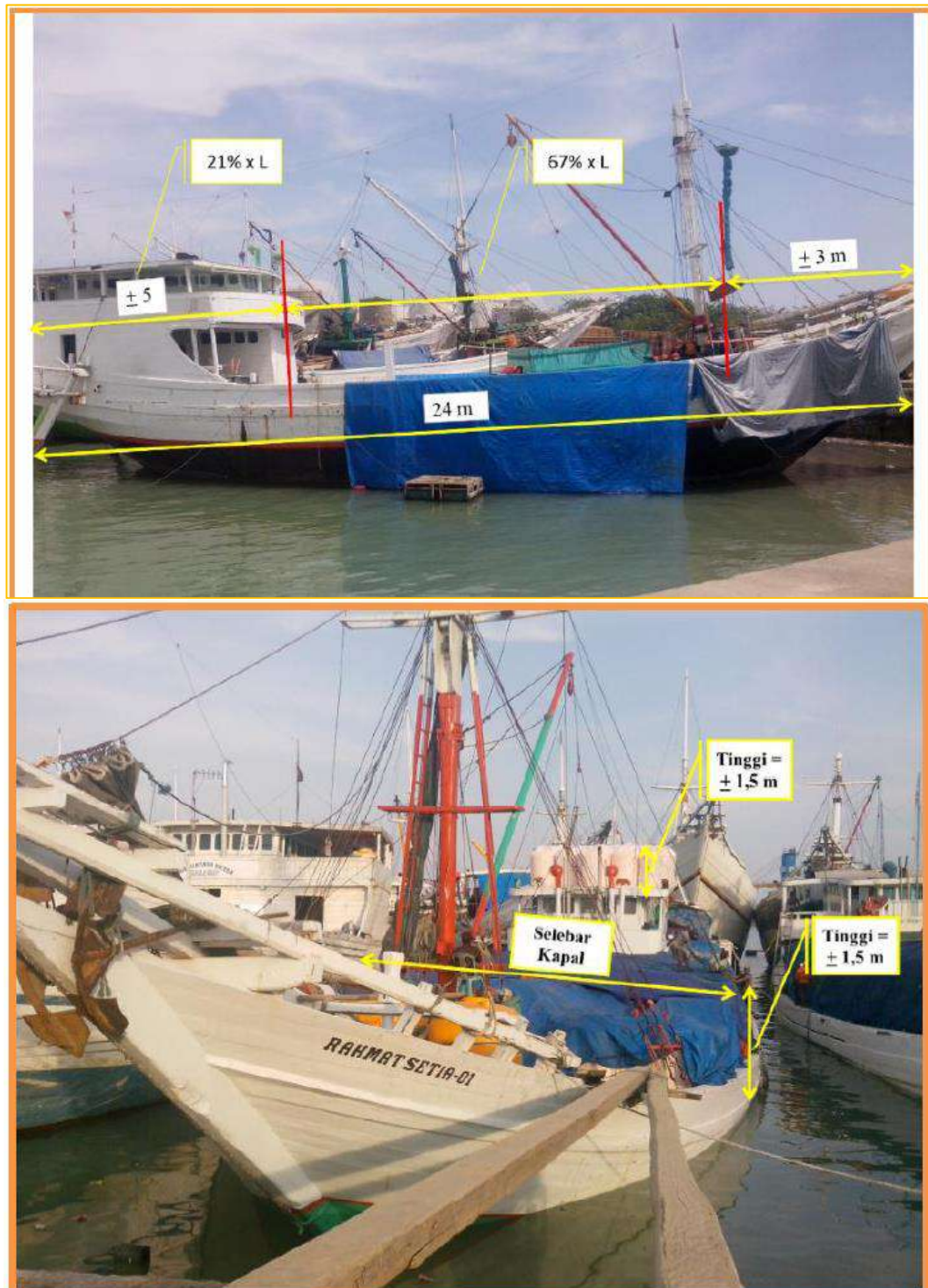
Gambar 4-9 Peletakan Muatan di Kapal Pelra
