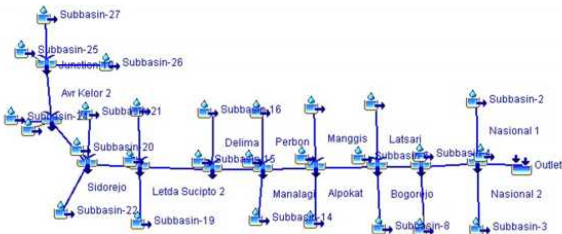
Gambar 4.2. Model Tangkapan Air Saluran Afvour Kelor dengan Program HEC-HMS
