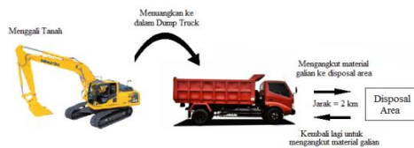
Gambar 2.3 Skema Pekerjaan Galian Tanah
