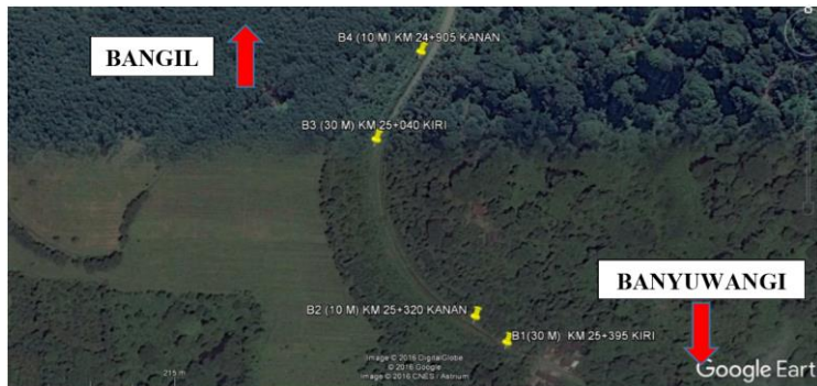
Gambar 5.16 Lokasi Titik Bor & SPT KM. 24+800 - 25+400
