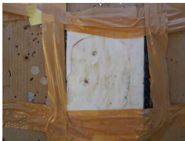
Gambar 3.15 Hasil pengujian balistik
