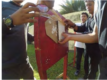
Gambar 3.13 Peletakan spesimen uji pada papan target
