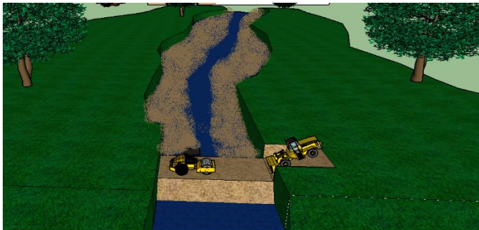
Gambar 4. 27 Pengelakan Sungai dalam keadaan di bendung/ checkdam di lapangan versi 3D
