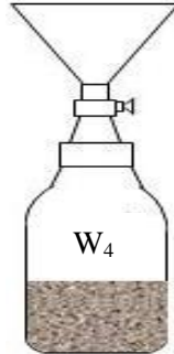
Gambar 2. 11 Kerucut, botol, dan sisa pasir Ottawa Sumber : lauwtjunnji.weebly.com/tahapan-uji-sandcone
