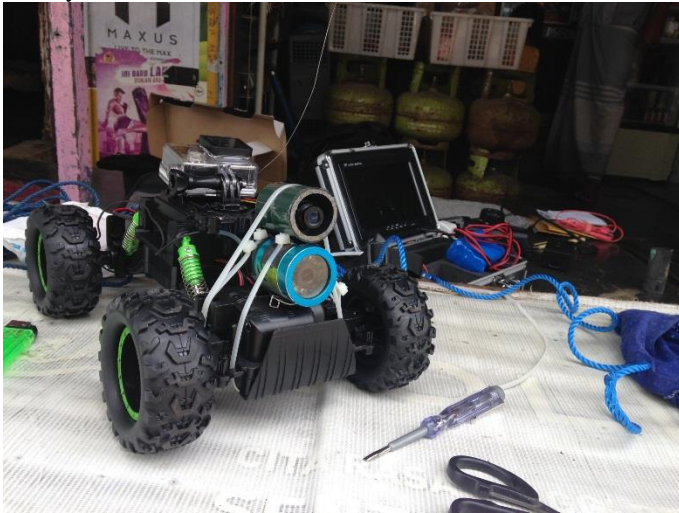
Gambar A-1 Mobil RC dan 3 set kamera
