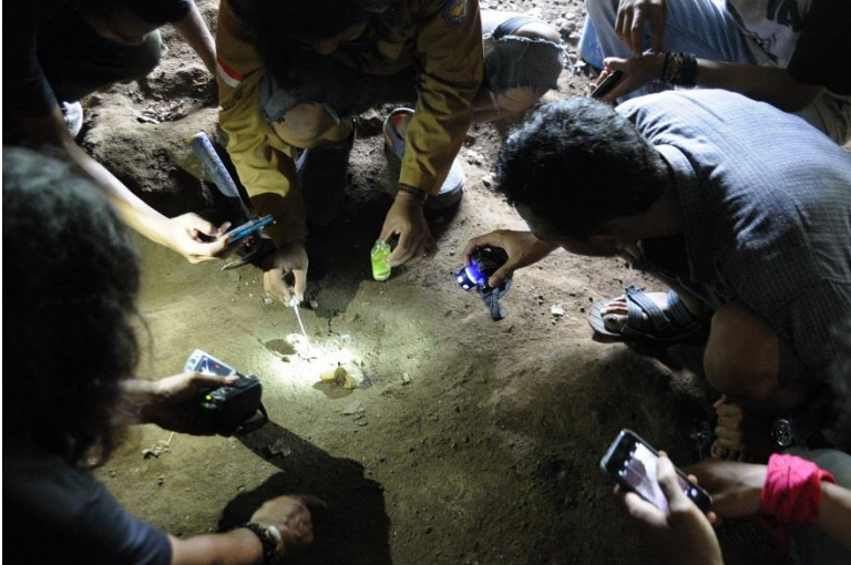
Gambar A-11 Pengujian HCl pada batuan di Situs Maelang
