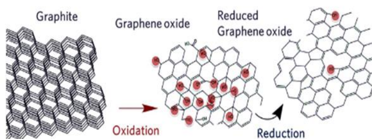
Gambar 2.5 Struktur dari grafit, grafena oksida, dan grafena oksida tereduksi ( https://www.utu.fi/ )
