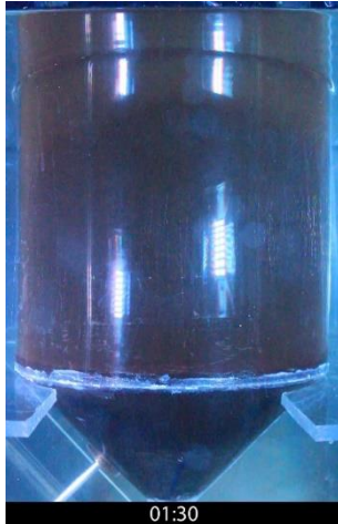
Gambar IV.37 Perbandingan Kontur Konsentrasi pada Detik ke-90 dengan Kecepatan 1300 rpm
