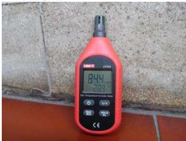
Gambar 3.1 Higrometer UNI-T yang digunakan sebagai acuan pengambilan data temperatur udara dan kelembaban udara
