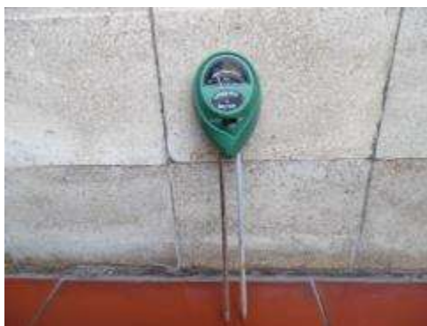
Gambar 3.5 Higrometer tanah dapat membantu menentukan nilai akurasi dari sensor kelembaban tanah
