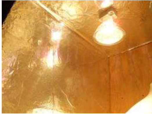
Gambar 3.2 Lampu halogen digunakan untuk memanaskan keadaan didalam box
