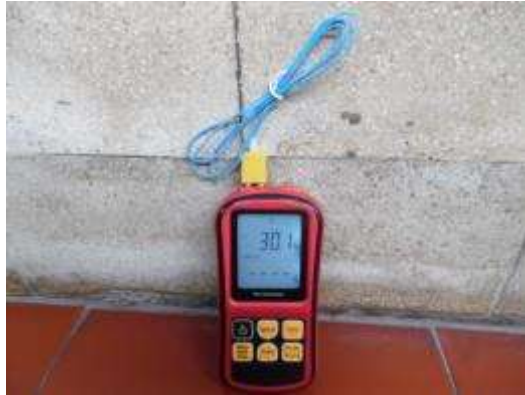
Gambar 3.3 Termokopel tipe-K digunakan sebagai acuan untuk menentukan akurasi sensor temperatur tanah
