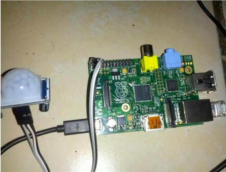
**Gambar 4.1:** Implementasi Raspberry Pi dengan sensor PIR
