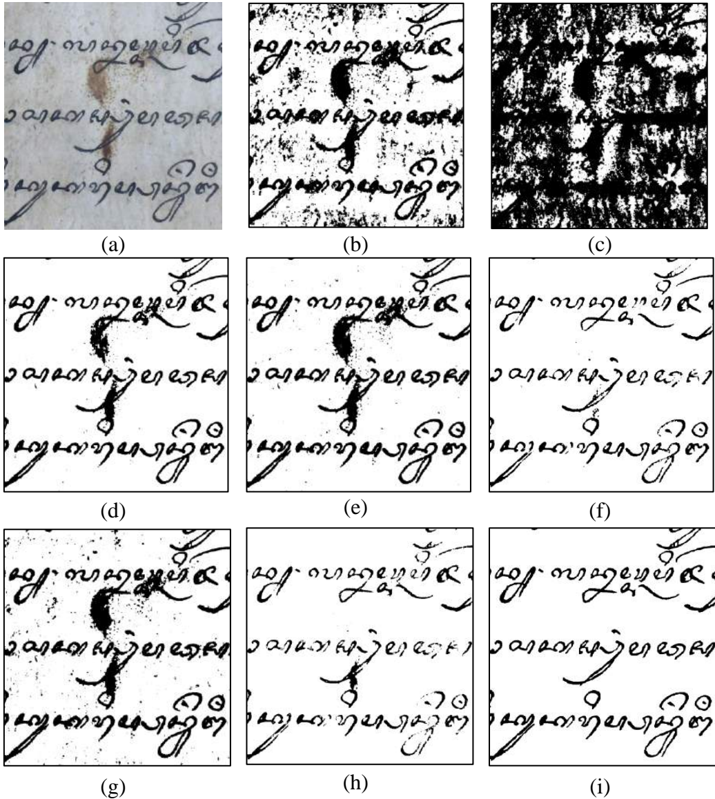
Lampiran 6 Hasil Binerisasi (a) Data Bercak Kemerahan Kedua Menggunakan Metode (b) Bernsen, (c) Niblack, (d) Otsu, (e) Phansalkar, (f) Sauvola, (g) Singh, (h) Metode Usulan dan (i) Ground-truth Data Bercak Kemerahan Kedua
