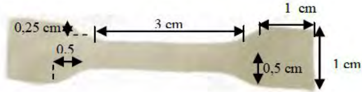
Gambar 3. 2 Dimensi sampel pengujian kuat tarik (Argo B.D., 2013)
