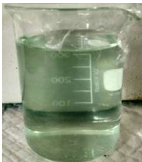
Gambar 4.23. Larutan hasil dari proses elektrolisis menggunakan metode sonikasi dengan konsentrasi natrium sitrat 0,3 M sebanyak 10 mL yang ditambahkan ke dalam 400 mL pada potensial 55 V tanpa penambahan CTAB, volume akhir air menjadi 390 mL
