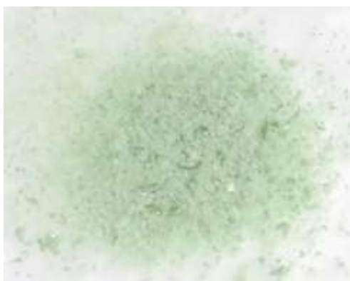
Gambar 4.12. Serbuk nikel sitrat yang disintesis dengan konsentrasi natrium sitrat 0,3 M sebanyak 10 mL yang ditambahkan ke dalam 400 mL air pada potensial 55 V, massa yang didapatkan sebanyak 0,3985 g
