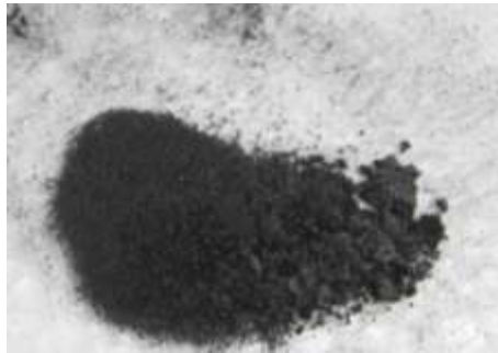
Gambar 4.13. Serbuk nikel oksida setelah dikalsinasi pada suhu 600 °C, massa yang didapatkan sebanyak 0,1879 g
