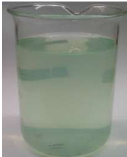
Gambar 4.22. Larutan hasil dari proses elektrolisis dengan metode sonikasi dengan menggunakan konsentrasi natrium sitrat 0,3 M sebanyak 10 mL yang ditambahkan ke dalam 400 mL air pada potensial 55 V dengan penambahan CTAB, volume akhir air menjadi 390 mL
