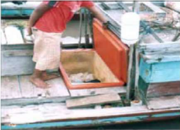
Gambar 2.12. Cool-box kapasitas 200 kg di kapal rawai 3-4 GT/3 PK
