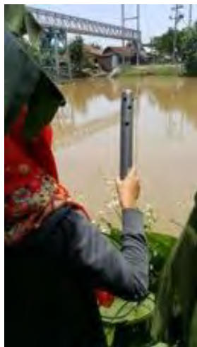
Gambar 3.6. Pemasangan sensor di lokasi.
