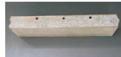
Dinding quipanel dengan konduit
