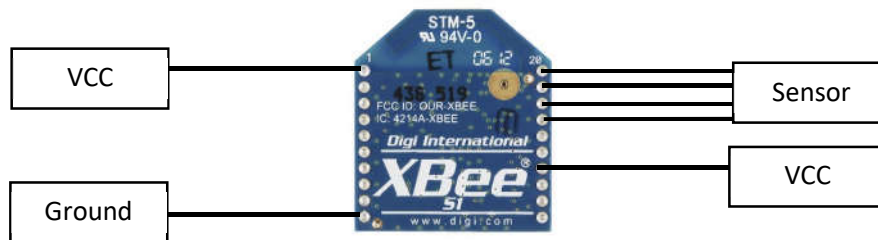
Gambar 3.9 Skema Transmitter menggunakan XBEE S1
