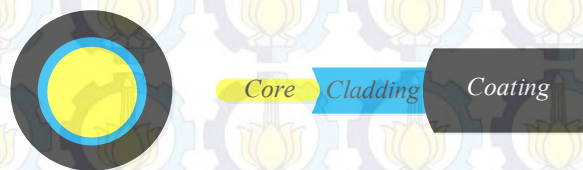
Gambar 2.25 Struktur dasar serat optik
