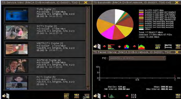
Gambar 2.1: Efisiensi penggunaan kanal pada siaran TV digital berdasarkan hasil pengukuran dengan Pixelmetrix
