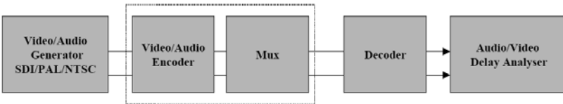
Gambar 5.25: Konfigurasi pengukuran delay relatif audio/video [ETSI, 2001]
