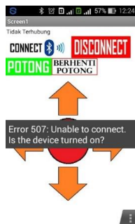
Gambar 4. Pemberitahuan Error Ketika Tombol Arah Panah Keatas Ditekan Tanpa Terhubung dengan Bluetooth
