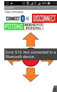
Gambar 5. Pemberitahuan Error Ketika Tombol Arah Panah Keatas Ditekan Tanpa Terhubung dengan Bluetooth
