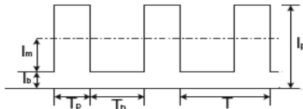
FIG.1 – Principe du courant pulsé sur le TIG
