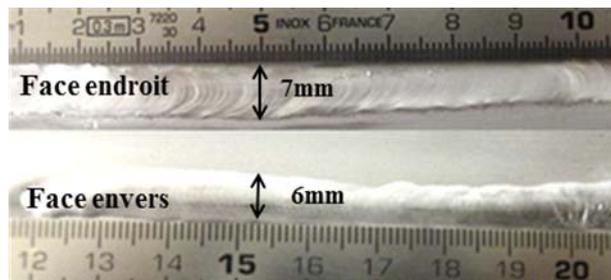
FIG.4 – Soudure 2024-T3 avec métal d'apport 5356 selon les paramètres opératoires optimisés.
