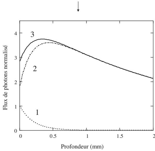
Fig. 2. Évolution du flux de photons normalisé le long de l'axe du faisceau ( $\mu_a = 0,01 \text{ mm}^{-1}$ ,  $\mu'_s = 1 \text{ mm}^{-1}$  et  $r_0 = 5 \text{ mm}$ ). 1-Flux collimaté normalisé  $\Phi_c(0, z)/\Phi_c(0, 0)$ , 2-Flux diffusé normalisé  $\Phi_d(0, z)/\Phi_c(0, 0)$ , 3-Flux total normalisé  $\Phi(0, z)/\Phi(0, 0)$ .
