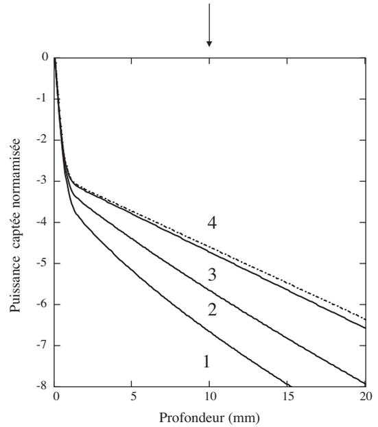
Fig. 6. Évolution du logarithme de la puissance lumineuse normalisée  $P(0, z)/P(0, 0)$  le long de l'axe du faisceau ( $\mu_a = 0,01\text{mm}^{-1}$ ,  $\mu'_s = 1\text{mm}^{-1}$ ). 1-  $r_0 = 5\text{mm}$ , 2-  $r_0 = 10\text{mm}$ , 3-  $r_0 = 40\text{mm}$ , 4-  $r_0 \rightarrow \infty$ .
