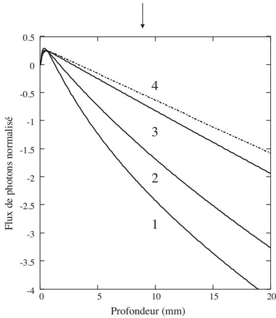
Fig. 5. Effet du rayon du faisceau sur  $\ln(\Phi(0, z)/\Phi(0, 0))$  ( $\mu_a = 0,01\text{mm}^{-1}$ ,  $\mu'_s = 1\text{mm}^{-1}$ ). 1-  $r_0 = 5\text{mm}$ , 2-  $r_0 = 10\text{mm}$ , 3-  $r_0 = 40\text{mm}$ , 4-  $r_0 \rightarrow \infty$ .
