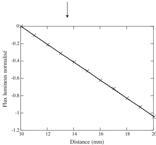
Fig. 11. Évolution de  $\ln(r\Phi(r)/10\Phi(10))$  lorsque la distance  $r$  est comprise entre 10 mm et 20 mm. (++++) courbe expérimentale et (–) droite ajustée.
