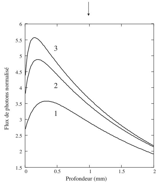
Fig. 4. Effet du coefficient de diffusion sur  $\Phi(0, z)/\Phi_c(0, 0)$  ( $\mu_a = 0,01 \text{ mm}^{-1}$ ,  $r_0 = 5 \text{ mm}$ ). 1-  $\mu'_s = 0,5 \text{ mm}^{-1}$ , 2-  $\mu'_s = 1 \text{ mm}^{-1}$ , 3-  $\mu'_s = 2 \text{ mm}^{-1}$ .
