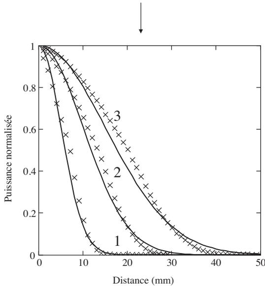
Fig. 8. Répartition radiale de la puissance normalisée  $P(r)/P(0)$  mesurée à la surface du hublot. 1-  $r_0 = 10\text{mm}$ , 2-  $r_0 = 20\text{mm}$ , 3-  $r_0 = 30\text{mm}$  : (++) Courbes expérimentales et (-) Gaussiennes ajustées.
