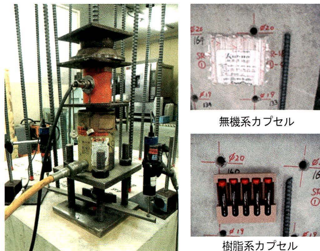
写真-1 試験装置と各種アンカー
