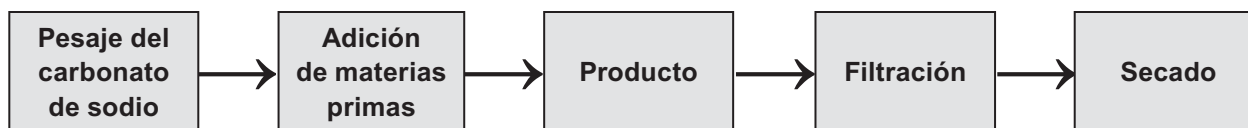
Gráfica 3. Diagrama de bloques del montaje experimental
