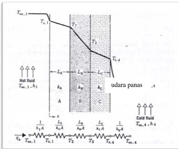
Gambar 1 Ilustrasi perpindahan panas lewat dinding
