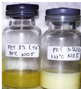
**Gambar 5.3** Sintesis PZT variasi 3:3 dengan percobaan suhu refluks akhir. Ket. 70°C (kiri) dan 110°C (kanan). Terdapat suspensi pada hasil sintesis, semakin tinggi suhu refluks semakin banyak terbentuk.
