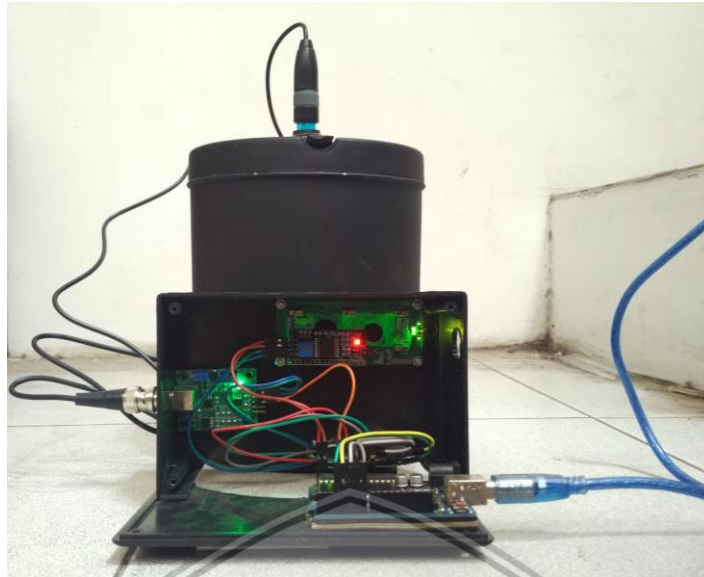
Gambar 5.10 Implementasi Arduino Uno dan pH Kit Pendeksi Madu
