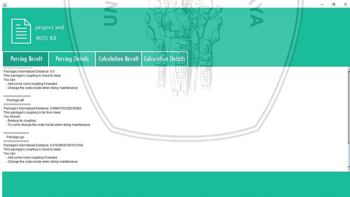
Gambar 6.10 Antarmuka hasil perhitungan kopling secara garis besar
