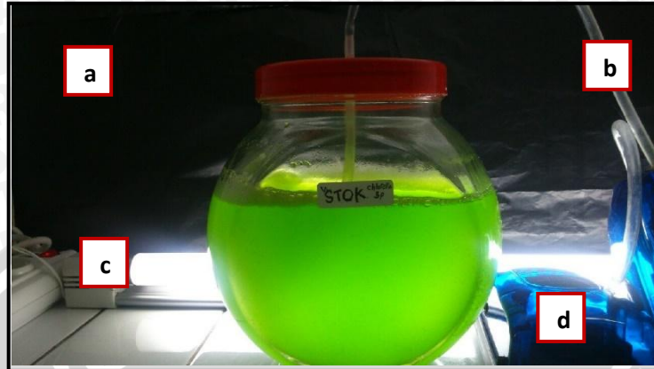
Gambar 3.2 Susunan Peralatan Pembuatan Stok Kultur Chlorella sp pada Volume 1,5L Keterangan : (a). Plastik Penutup; (b) Selang Aerasi; (c) Lampu TL 18 watt; (d) Aerator
