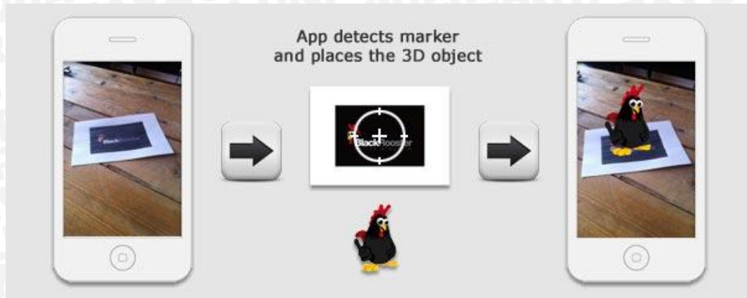
Gambar 4.3 Konsep Augmented Reality dengan Marker
