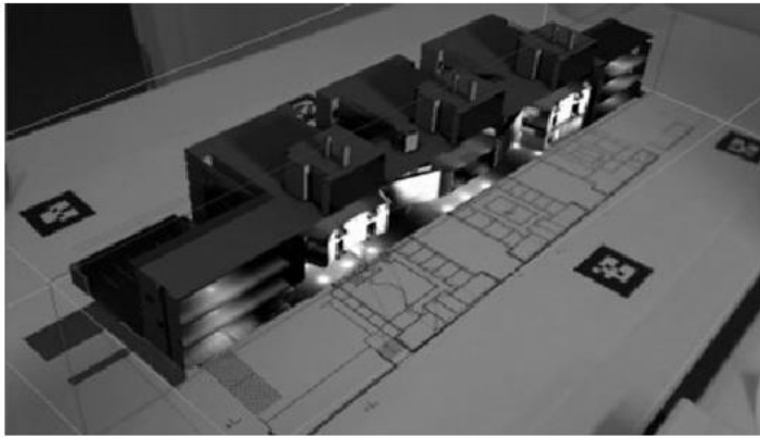
Gambar 2.3 Contoh penampakan denah gedung secara virtual berdasarkan Augmented Reality berbasis marker dan contoh marker.
