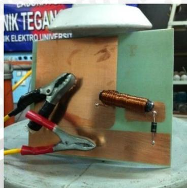
Gambar 4.18 Pengujian kaskade arester dengan elemen dekoupling
