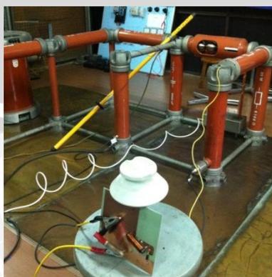
Gambar 3.4 Pengujian arester
