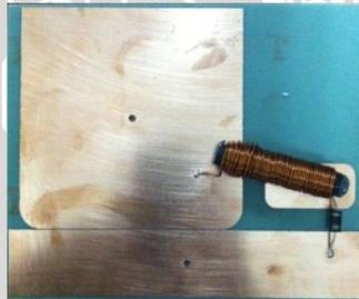
Gambar 4.17 Hasil rancang bangun kaskade arester dengan elemen dekopling
