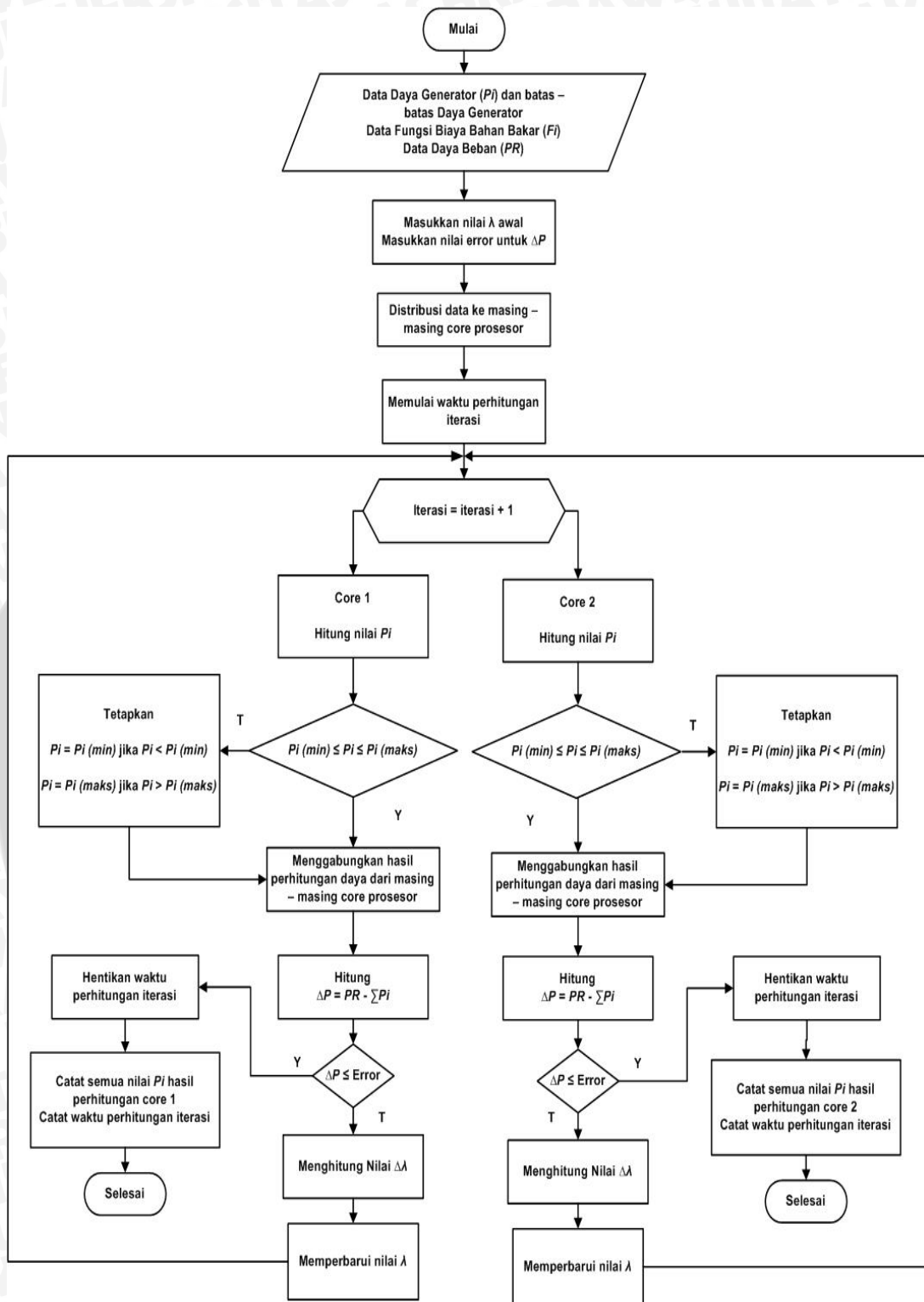
Gambar 3.4 Diagram alir perhitungan operasi ekonomis metode iterasi lambda komputasi paralel
